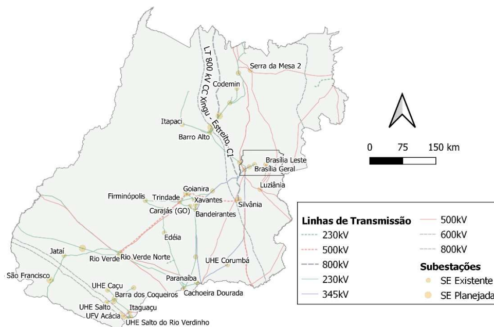
Figura 1-1 - Sistema de Transmissão do Estado de Goiás
